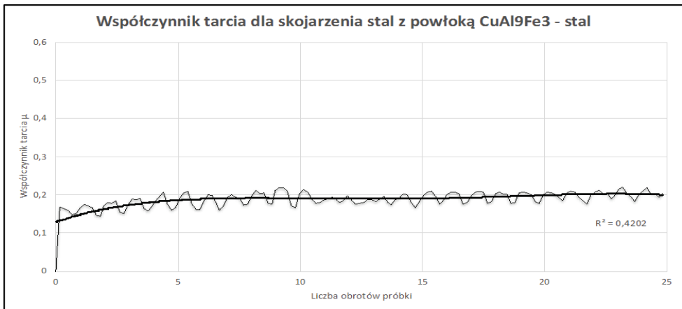
Rys. 5. Wyniki pomiaru współczynnika tarcia skojarzenia stal z powłoką z brązu aluminiowego – stal
